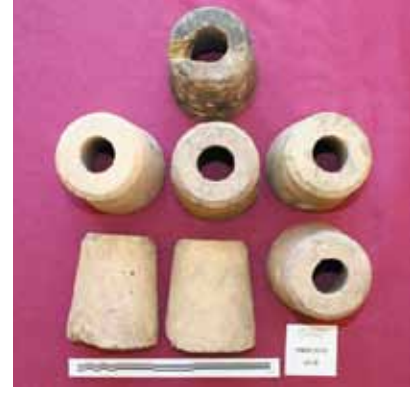
Demirköy Fatih Dökümhanesi – Demir Fırınlarına Ait Üfleçler (Foto: H.A. Yazıcı)
